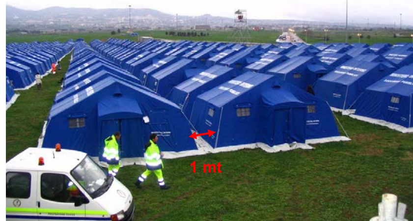
Disposizione e spaziatura moduli all'interno del campo
